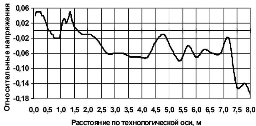
Рис. 5. Изменение напряжений в поверхностном слое заготовки из Ст 20 сечением 335 \times 400 мм, разливаемой со скоростью 0,6 м/мин
